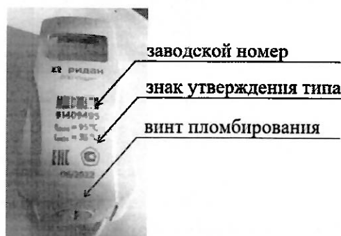
Рисунок 2 — Места нанесения заводского номера, знака утверждения типа, пломбирования
