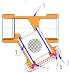
Фильтр состоит из корпуса 1, заглушки 2, фильтроэлемента 3, центрирующей втулки 4 и прокладки 5. Корпус и заглушка выполнены из горячепрессованной, никелированной латуни марки СW617N. Центрирующая втулка служит для фиксации фильтроэлемента в фильтровальной камере и
